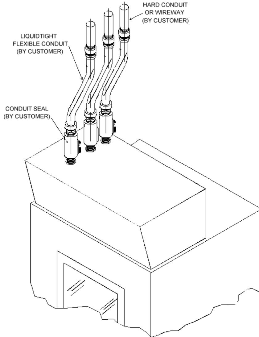
**Figure 2-3a: Conduit and Conduit Seals**
